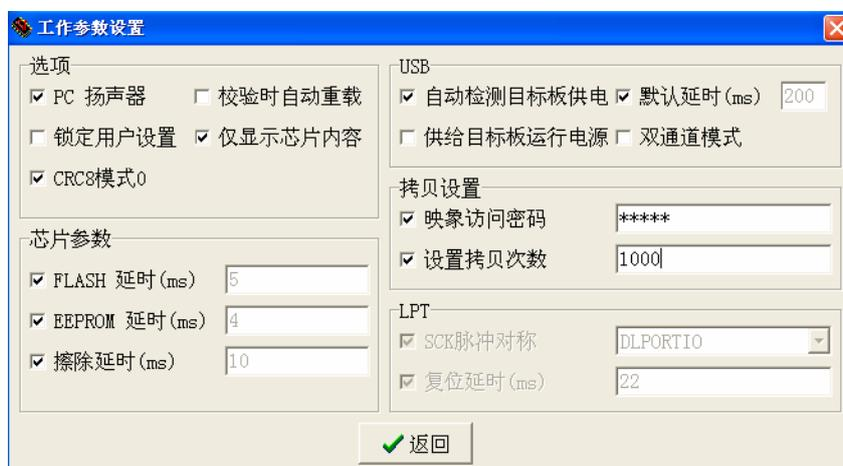
A、如果“映像访问密码”打钩，用户可以在右边的编辑框中输入一个密码，这个密码在对 Image 存储器进行编程时会一起写入到 Image 存储器中；此后如果用户对 Image 存储器进行校验、读取访问时，SLISP 会要求用户输入相关的密码后才允许访问。
