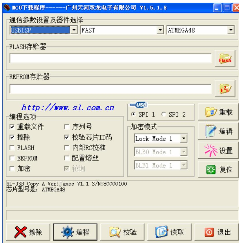
2、如果您的设备是 USB Isp，则只可以使用 SPI 1 通道；如果您的设备是 USB Copy，则可以选择 SPI 1 或 SPI 2 通道。SPI 1 和 SPI 2 通道分别对应 USB Copy 型下载线的两个 ISP 接口。
