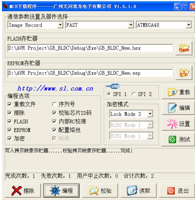
2、此时使用擦除、编程、校验和读取均是对 Image 存储器进行操作，当选择“Image Record”时，“复位”按键的功能变成“测试”，按动此按钮和按动 USB Copy 上的拷贝启动按钮是等效的，可以启动一次的新的脱机拷贝。
